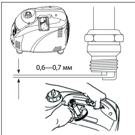
Зазор между электродами должен составлять 0,6-0,7 мм.
