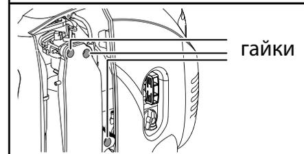
Снимите корпус **1** воздушного фильтра: **только для ЗИГ-1200** - поднимите пружинные фиксаторы; **кроме ЗИГ-1200** - отверните гайки крепления.
